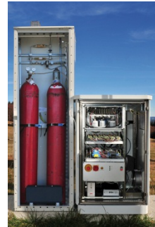
Links: Öffentliche, solare Wasserstofftankstelle des Fraunhofer ISE. © Fraunhofer ISE Rechts: Autonomer, außertauglicher Teststand zur parallelen Untersuchung von dreißig Testzellen. © Fraunhofer ISE
